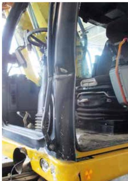
*Typischer Fall einer leichten Beschädigung des A-Holmes, die relativ einfach zu reparieren ist.*
