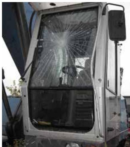
*Einer der vielen leicht instandsetzbaren Schäden an Frontscheibe, Haltestange und A-Holm.*
