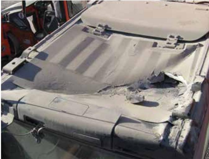
**Dachschaden an einer ROPS/FOPS-Fahrerkabine** mit Beschädigung der Blech-Dachhaut. Die eigentliche ROPS-Schutzkonstruktion blieb unbeschädigt.
