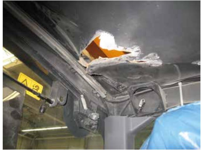
**Zur Reparatur** wurde das Blech völlig entfernt und ein nachgefertigtes Teil eingeschweißt.
