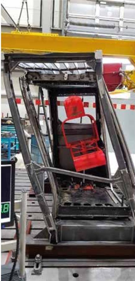
**Test zur Zertifizierung** der ROPS/FOPS-Schutzkonstruktion mit normgemäßen Kräften. Der Fahrer auf dem roten Sitz bliebe trotz Verformung der Kabine geschützt.
