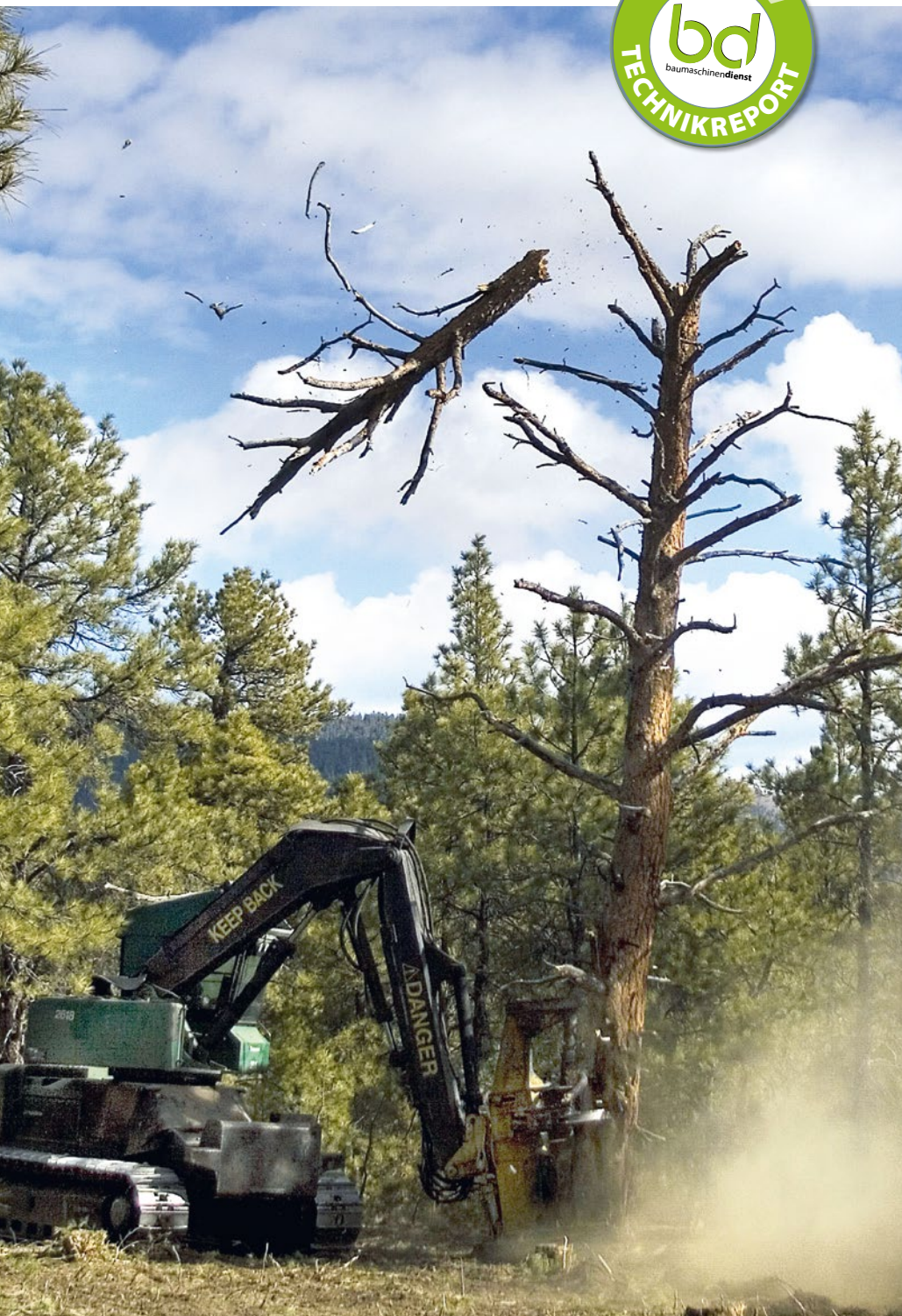
Geprüfte Sicherheit: Der sogenannte Verformungsgrenzbereich soll den Fahrer vor herabfallenden Gegenständen sicher schützen. (Bild: Forest Operations Engineering)
