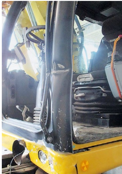
Passiert sehr oft: Schaden am A-Holm der Kabine durch Anfahren mit der Lkw-Kippmulde. (Bilder: Dienstbier)
